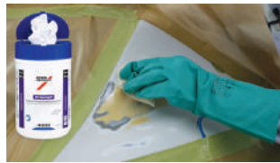
2. 작업면 방청 처리 4000 방청 전처리제 와이프(Wipe)로 칠판이 드러난 부분에 사용하여 닦아냄. *비닐백에 담아 밀봉한 후 차후 단계에 사용 가능. 닦아낸 방청 처리면은 15분 내에 서페이스 후속도장 진행
