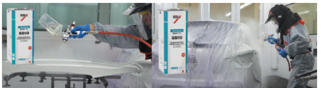
8. 클리어코트 도장 HS 스피드 클리어코트 8810으로 1.5회 또는 2회 도장 *도장, 플래시 오프 및 60°C에서 건조까지 13분
