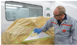
1. 뒷면 윈(Wing) 보수 도장 작업 부위 확인 샌딩 완료 후 언더코트 도장을 위한 준비 완료
