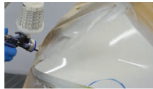
3. 서페이스 작업 HS 스피드 서페이스 5500으로 퍼티면에 1회 도장 후 필요한 도막 두께에 따라 추가 2-3회 웨트-온-웨트로 도장. * 20°C에서 20분만에 샌딩 가능
