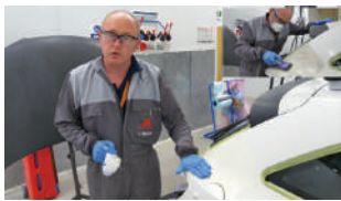
5. 뒷면 윈(Wing) 탑코트 도장을 위한 샌딩 작업 서페이스 도장면 건조 완료 후 탑코트를 위한 샌딩 작업 진행.
