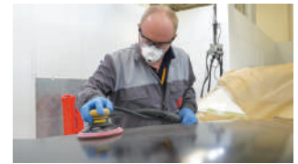
4. 본넷 샌딩 작업 뒷면 윈(Wing) 서페이스 건조 동안, 본넷 웨트-온-웨트 작업에 필요한 사전 작업 진행.
