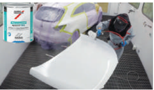
6. 본넷 서페이스 도장 HS 웨트-온-웨트 스피드 서페이스 5550으로 1회 가볍게 도장 후 거리를 가깝게 하여 고르게 도장. * 도장 및 20°C에서 플래시 오프까지 6분
